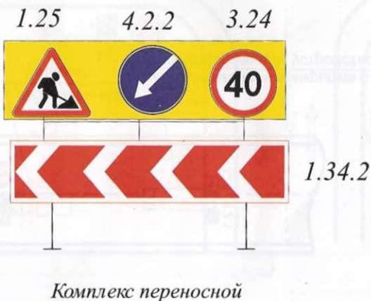
Рис. 5.28. Организация движения и ограждение мест производства краткосрочных дорожных работ
